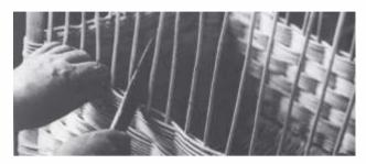
Mit einem flachen Eisen wird das Geflecht immer wieder verdichtet. Sind die Weiden ungeschält, wie bei Holz- oder Kartoffelkörben, ist es grüngeschlagene Arbeit. Hochwertige Flechtarbeiten wie Wäschekörbe oder Rückentragkörbe entstehen aus geschälter Weide (weißgeschlagene Arbeit).
