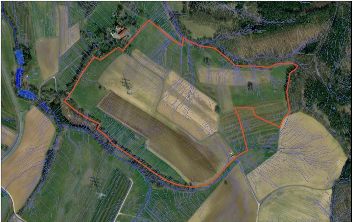
Abbildung 2: Ausschnitt Fließwege und Senken des Oberflächenabflusses im Untersuchungsgebiet
